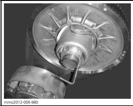
VARIAATTORIN AVAUSTYÖKALU ASENETTUNA SÄÄTIMEN NAPAAN
