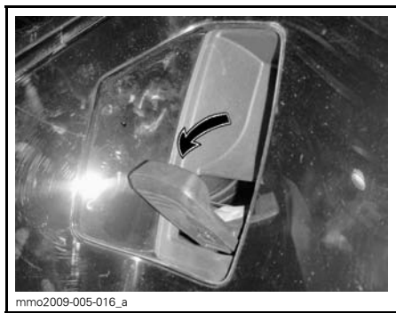
mmo2009-005-016_a VEDÄ KYTKEÄKSESI PERUUTUSVAIHTEN PÄÄLLE.
