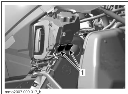
HÖGER SIDA AV MOTORRUMMET 1. Säkringarnas placering
