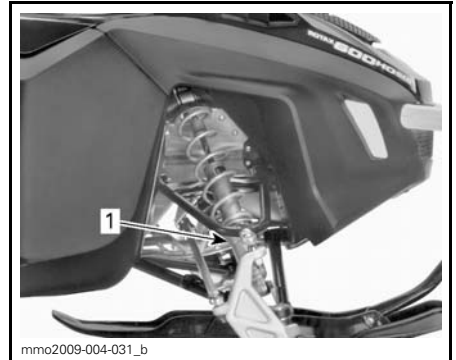
TYPBILD - FÖRSPÄNNING AV KAMTYP 1. Justeringskam
