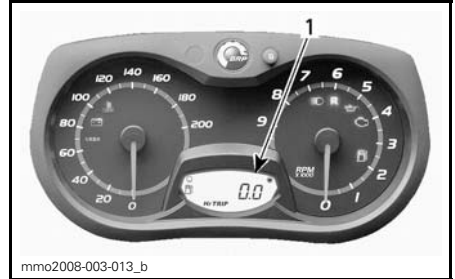
INDICATORE ANALOGICO / DIGITALE 1. Display digitale
