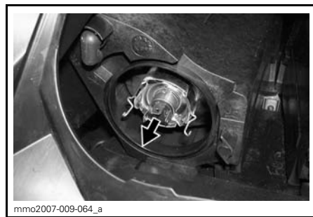
ESTRARRE LA LAMPADINA E SOSTITUIRLA
