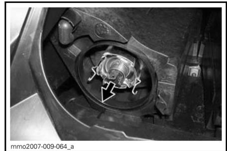
RETIREZ L'AMPOULE ET REMPLACEZ-LA
