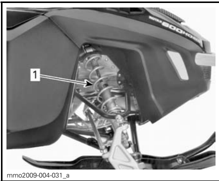
TYPISCH - VORDERE AUFHÄNGUNG 1. Vordere Federn für Fahrverhalten
