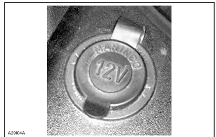
27) 12-VOLT POWER OUTLET
