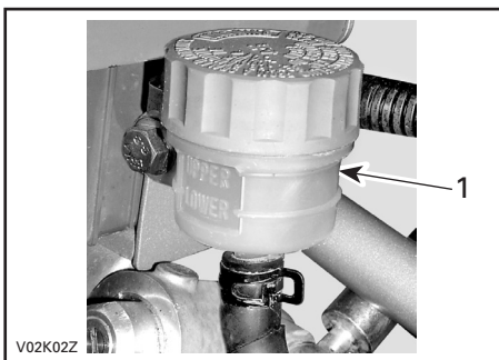
1. Réservoir de liquide de frein arrière
