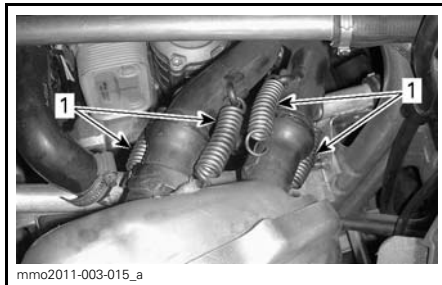
1. Fästfjädrar mellan avgasrör och ljuddämpare
