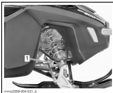
TYPBILD - FÖRSPÄNNING AV KAMTYP 1. Justeringskam
