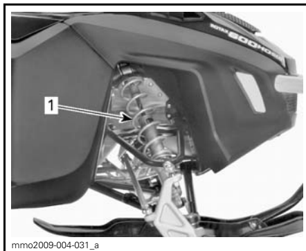
TYPBILD - FRAMFJÄDRING 1. Framfjädrar för manövrering
