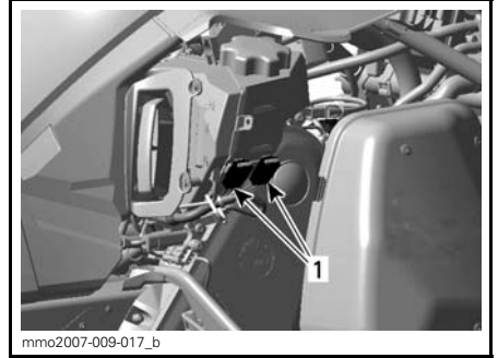
MOOTTORITILAN OIKEA PUOLI 1. Sulakkeiden sijainti
