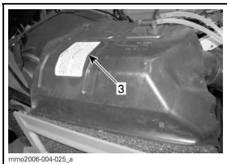
mmo2006-004-025_a ÄÄNENVAIMENNIN (RUNGON PUOLI) — PUHALLINJÄÄHDYTYTEINEN
