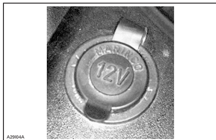
TIPICA — PRESA DI ALIMENTAZIONE ELETTRICA
