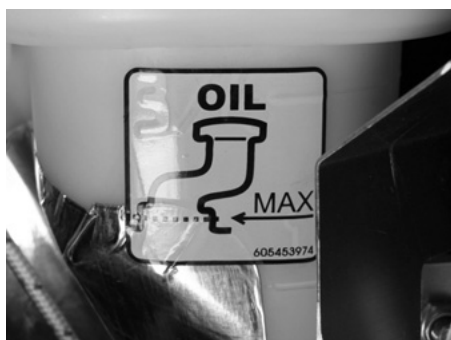
SE PÅ DEKALEN FOR MAKSIMUM OLJENIVÅ PÅ INNSIDEN AV OLJELOKKET
