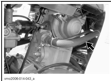
POSIZIONE PINZA DI STROZZAMENTO
