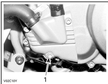
1. Bouchon de vidange du liquide de refroidissement
