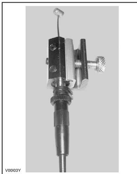
Insérer l'aiguille du vaporisateur dans l'orifice du huileur.
