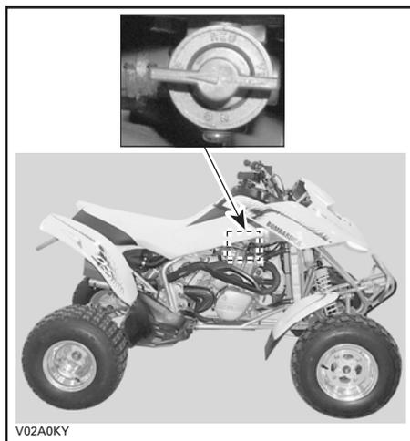
**ATTENTION:** Si le robinet de carburant n'est pas bien aligné sur la position «ON», son ouverture est incomplète et l'écoulement de carburant peut être insuffisant. S'assurer que le robinet est complètement ouvert pendant l'utilisation.
