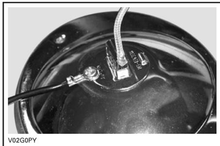
Détacher l'ampoule et la remplacer.
