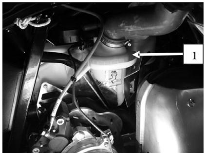
1. Maximal oljenivå. (Fyll inte på för mycket.)
