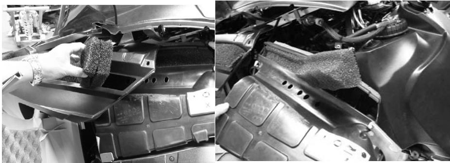
*Kontrollera att ljuddämparen är ren och torr och återmontera filtret.*
