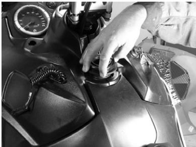
Lossa den stora plastmutter som sitter runt bränsletankens påfyllningsöppning.
