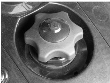
*Skruva loss för att fylla tanken och skruva sedan åt helt.*
