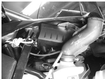
Öppna säkringsboxen genom att trycka på lockets spärr och lyfta locket.
