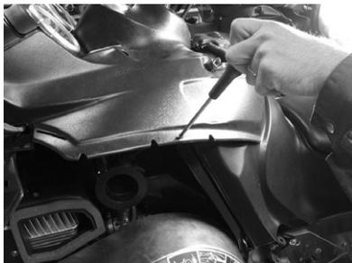
*Lossa de två panelsidskruvarna.*
