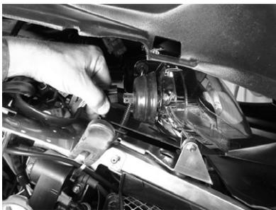
Lyft konsolens bakkant tills du har tillräckligt med plats för att arbeta med strålkastarlamporna. Ta loss kopplingen till den trasiga lampan. Ta loss gummiskon.
