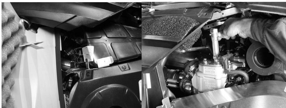
**Vissa modeller:** Tändstiftsbehållaren i motorutrymmet är till för att hålla tändstiften torra och skydda dem mot stötar som kan påverka inställningarna eller skada dem.
