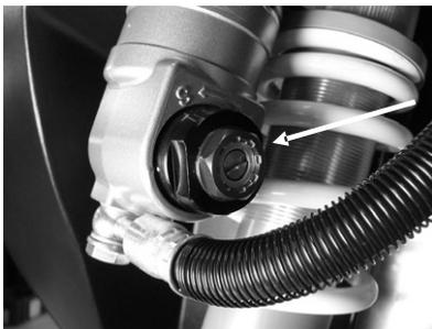
Justeringsratt för kompressionsdämpning (i tillämpliga fall).
