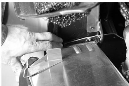
Lyft framsidan på skyddet uppåt och vrid det utåt från fordonet för att ta bort det.
