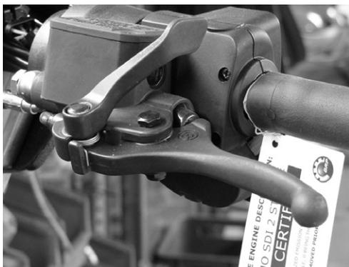
Placerat på vänster sida av styrstången. Du bromsar genom att trycka in det. När du släpper det, återgår det automatiskt till det ursprungliga läget. Bromseffekten är beroende av trycket som utövas på handtaget, typen av terräng och typen av snö.
