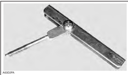
Ein- und Ausbauwerkzeug für den Keilriemen
