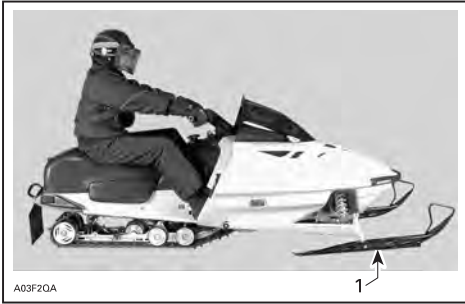
Anschlagriemen zu lang 1. Die Skis verlieren den Bodenkontakt. ODER
