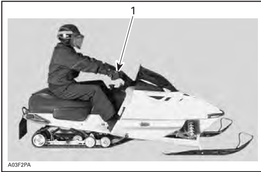
Gute Einstellung bei mäßiger Geschwindigkeit 1. Der Lenkergriff lässt sich leicht drehen – neutrales Lenkverhalten
