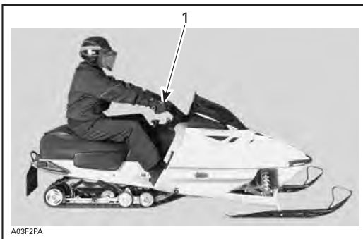
Zu weiche Einstellung 1. Der Lenkergriff lässt sich schwerer drehen - übersteuertes Lenkverhalten
