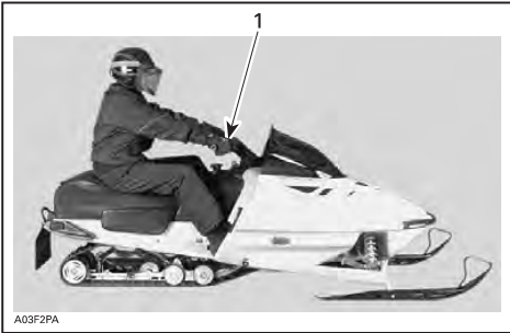
Anschlagriemen zu kurz 1. Schwergängige Lenkung
