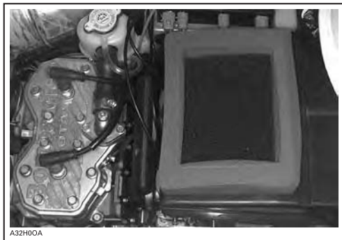
FILTRO SECONDARIO INSTALLATO SUL SILENZIATORE DELL'ARIA
