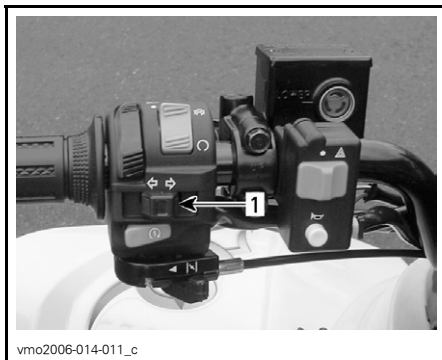
1. Reglage för körriktningvisare
