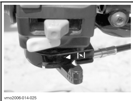
TYPBILD — CHOKEREGLAGET I STÄNGT LÄGE
