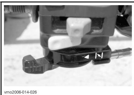
TYPBILD — CHOKEREGLAGET I HELÖPPET LÄGE
