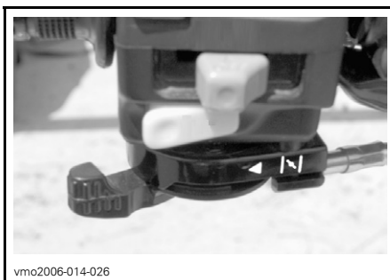
NORMAL — ALAVANCA DO AFOGADOR NA POSIÇÃO DE AFOGAMENTO TOTAL
