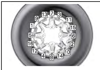
VANLIG – ÅTDRAGNINGSEKVENSN
