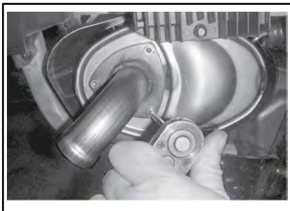
TYPEBILDE – FJERNING AV UTBLÅSINGSRØR
