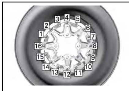
TYPEBILDE – TILTREKKINGSREKKEFØLGE SISTE TILTREKKING
