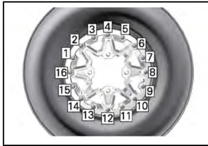
TYPEBILDE – TILTREKKINGSREKKEFØLGE SISTE TILTREKKING
