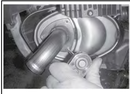
TYPISCH - UITLAATPIJP VERWIJDEREN
