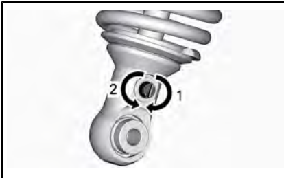
UITGAANDE DEMPING - BOVENZIJD VAN SCHOKDEMPER
