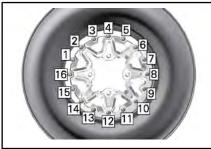
TYPISCH - LAATSTE AANDRAAI VOLGORDE
