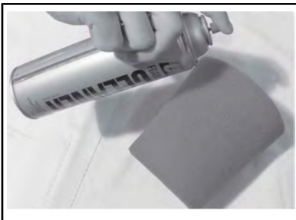
TYPISCH - SPIJT HET OP DE SCHUIMFILTER
