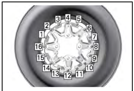
TYPISCH - LAATSTE AANDRAAIVOLGORDE
