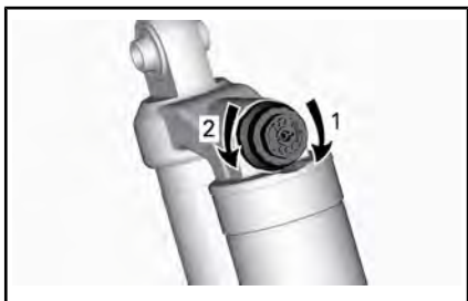
SMORZAMENTO IN COMPRESSIONE - PARTE SUPERIORE DELL'AMMORTIZZATORE
