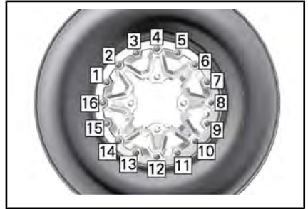
SITUAZIONE TIPICA - SEQUENZA DI SERRAGGIO FINALE
