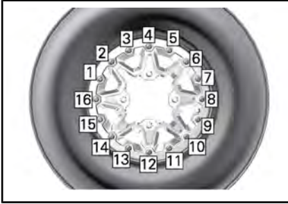
SITUAZIONE TIPICA - SEQUENZA DI SERRAGGIO FINALE
