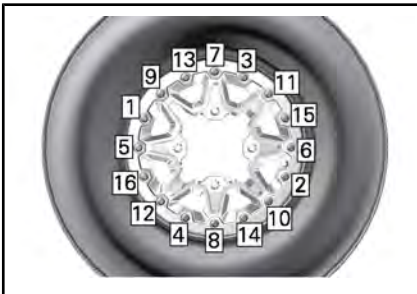
TYYPILLINEN KIRISTYSJÄRJESTYS
