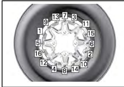
TYYPILLINEN KIRISTYSJÄRJESTYS
