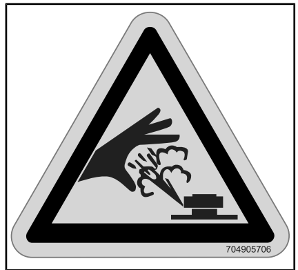
LABEL 13 - BEVINDT ZICH OP HET KOELVLOEISTOFRESERVOIR
