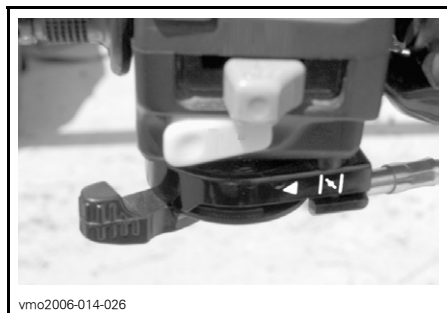
POSICIÓN DE ESTRANGULADOR TOTALMENTE ABIERTO
