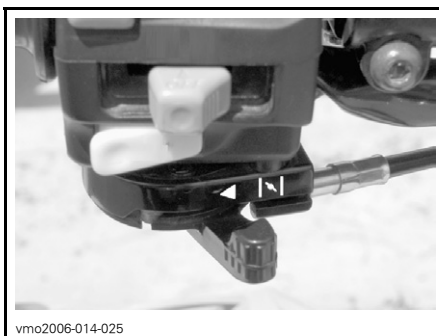
TÍPICO — PALANCA DEL ESTRANGULADOR EN LA POSICIÓN DE CIERRE
