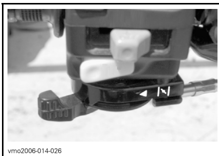
TÍPICO — PALANCA DEL ESTRANGULADOR EN LA POSICIÓN DE APERTURA TOTAL
