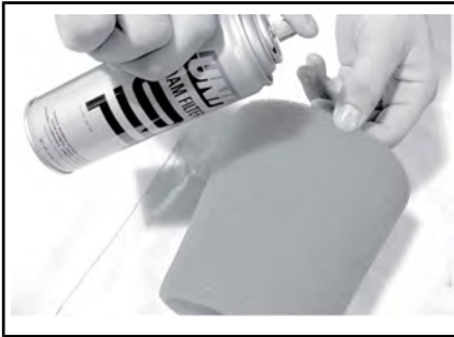
ТИПОВОЙ ВАРИАНТ - НАНЕСЕНИЕ МАСЛА НА ПОРОЛОНОВЫЙ ФИЛЬТР
