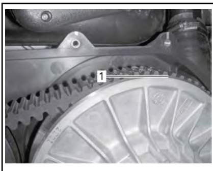
1. Нижние поверхности канавок ремня вариатора вровень с краем ведомого шкива
