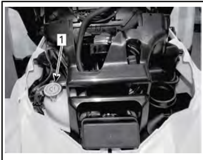
1. Serbatoio liquido refrigerante motore
