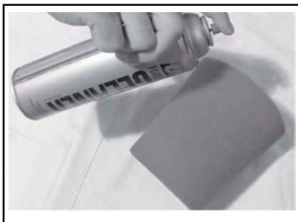
SITUAZIONE TIPICA - SPRUZZARE IL FILTRO IN MATERIALE ESPANSO
