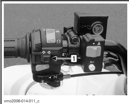
1. Schalter für Fahrtrichtungsanzeiger
