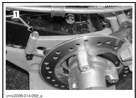
1. Stützbolzen für den Messtaster
