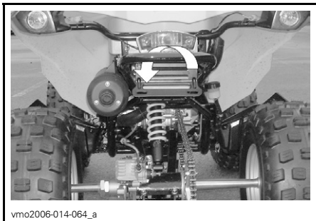
LAGE DES RIEMENS DES HINTEREN STOßFÄNGERS
