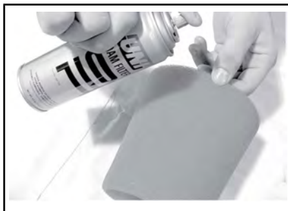
TYPISCH - FILTER MET OLIE SMEREN
