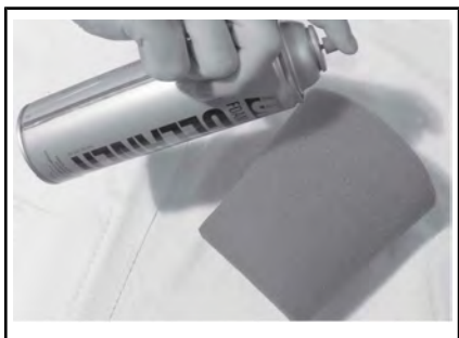
TYPISCH - SPIJT HET OP DE SCHUIMFILTER
