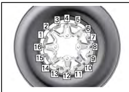
TYPISCH - LAATSTE AANDRAAIVOLGORDE
