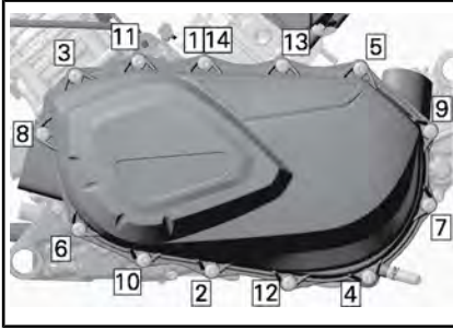
SEQUENZA DI SERRAGGIO DELLA CARENATURA DELLA CVT
