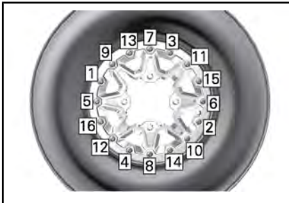
SITUAZIONE TIPICA - SEQUENZA DI SERRAGGIO
