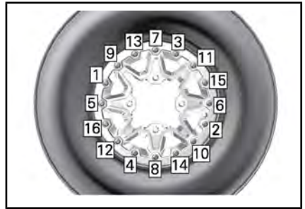
SITUAZIONE TIPICA - SEQUENZA DI SERRAGGIO
