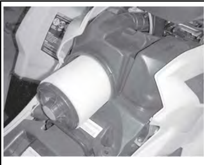
RIMOZIONE DEL FILTRO DELL'ARIA
