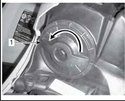
1. Copertura filtro dell'aria
