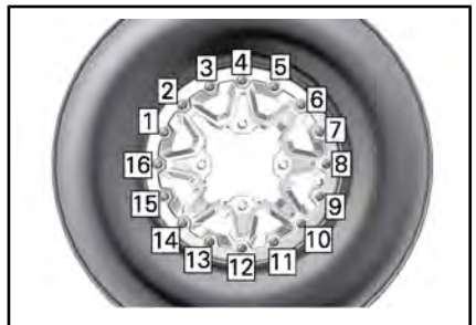
SITUAZIONE TIPICA - SEQUENZA DI SERRAGGIO FINALE
