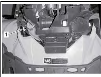
1. Tappo del serbatoio liquido refrigerante motore
