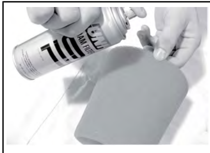
TÍPICO - LUBRIQUE EL FILTRO DE ESPUMA.
