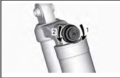
AMORTIGUACIÓN DE COMPRESIÓN - PARTE SUPERIOR DEL AMORTIGUADOR
