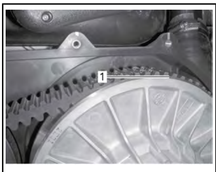
1. Porção mais baixa das engrenagens nivelada com a superfície externa da coroa de transmissão
