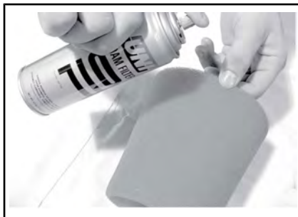
TÍPICO - LUBRIFIQUE O FILTRO DE ESPUMA
