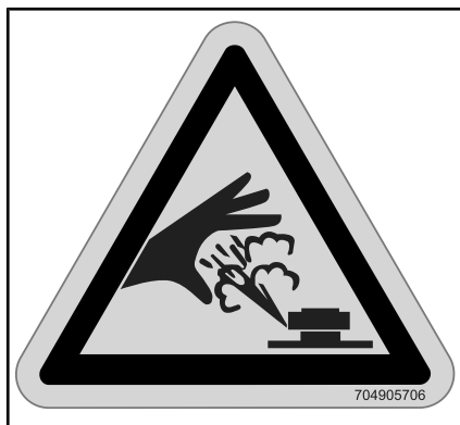
ETIQUETA 13 - LOCALIZADA NO RESERVATÓRIO DO LÍQUIDO DE ARREFECIMENTO
