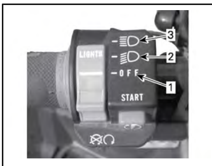
FUNÇÕES DO INTERRUPTOR DOS FAROL DIANTEIRO
