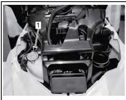
1. Réservoir du liquide de refroidissement
