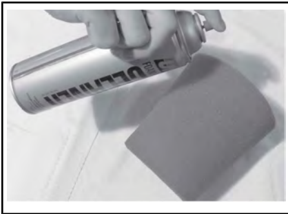
TYPIQUE - VAPORISEZ LE FILTRE EN MOUSSE
