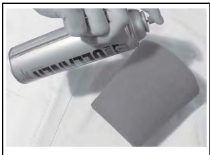
TYPISCH - SCHAUMSTOFFFILTER BE-SPRÜHEN
