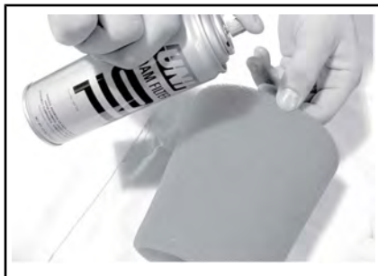
TYPISCH - SCHAUMSTOFFFILTER ÖLEN
