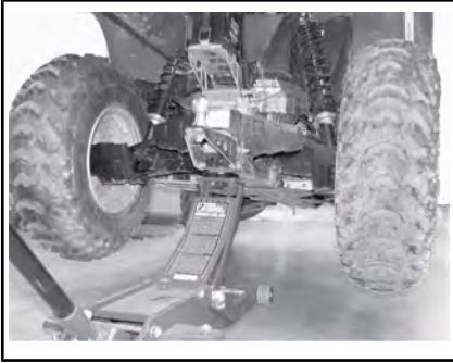
TYPISCH - PLAATS VAN HET KRIKPUNT ACHTERAAN
