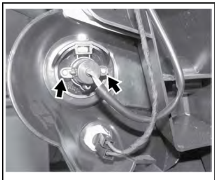
DÉVISSEZ LES VIS DE SÉCURITÉ DE L'AMPOULE DU CLIGNOTANT AVANT
