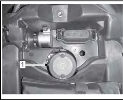
1. Behälter für Bremsflüssigkeit der hinteren Bremse
