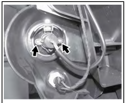
BEFESTIGUNGSSCHRAUBEN VON DER GLÜHLAMPE DES VORDEREN FAHRTRICHTUNGSANZEIGERS ABSCHRAUBEN
