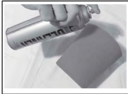
TYPISCH - SCHAUMSTOFFFILTER BESPRÜHEN
