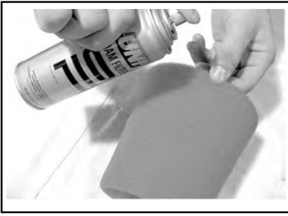
TÍPICO - LUBRIQUE EL FILTRO DE ESPUMA.
