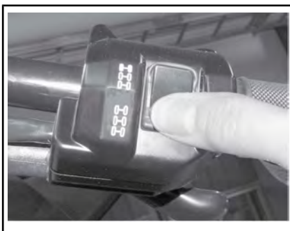
MODE 6 ROUES MOTRICES - TYPIQUE
