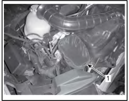
1. Filtre à air de la boîte de vitesses CVT
