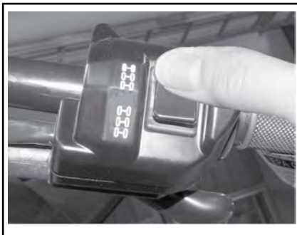
MODE 4 ROUES MOTRICES - TYPIQUE
