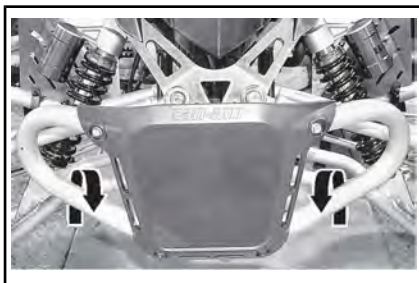
DS 90 X — LOCALIZAÇÃO DO PONTO DE FIXAÇÃO DIANTEIRO
