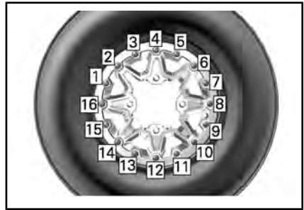
ТИПОВОЙ ВАРИАНТ - ЗАКЛЮЧИТЕЛЬНЫЙ ЭТАП ЗАТЯЖКИ ВИНТОВ
