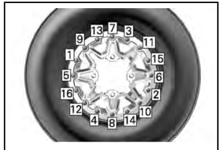
ТИПОВОЙ ВАРИАНТ - ПОРЯДОК ЗАТЯЖКИ ВИНТОВ
