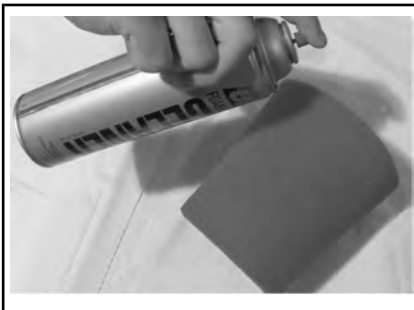
ТИПОВОЙ ВАРИАНТ – НАНЕСЕНИЕ МАСЛА НА ПОРОЛОНОВЫЙ ФИЛЬТР
