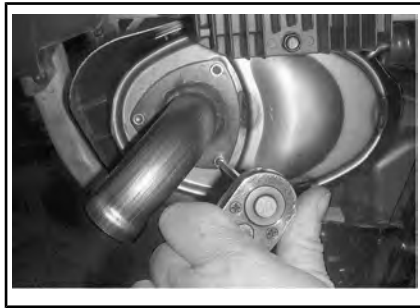
TÍPICO - RETIRE EL TUBO DE ESCAPE.
