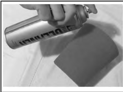
TÍPICO - ROCÍE EL FILTRO DE ESPUMA.
