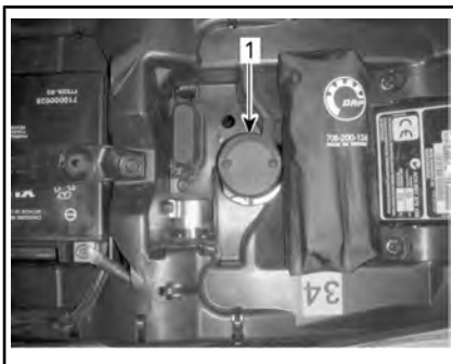
1. Bremsevæskebeholder for bremsar bak
