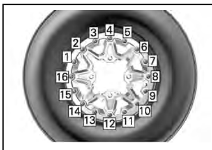
TYPEBILDE – TILTREKKINGSREKKEFØLGE SISTE TILTREKKING
