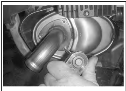
TYPEBILDE – FJERNING AV UTBLÅSINGSRØR
