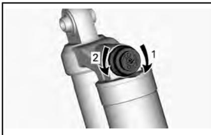
**SMORZAMENTO IN COMPRESSIONE - PARTE SUPERIORE DELL'AMMORTIZZATORE**
