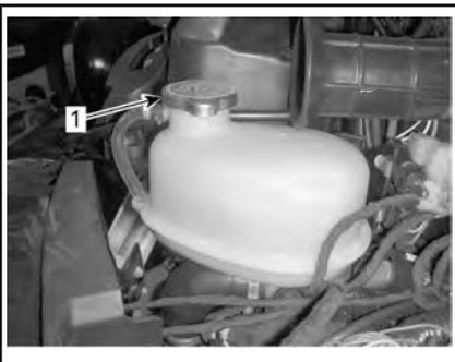
1. Tappo del serbatoio liquido refrigerante motore
