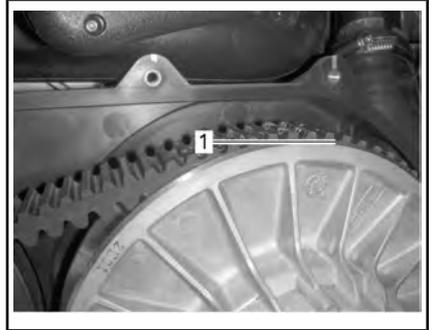
1. Porzione più bassa delle ruote dentate con la superficie esterna della cinghia di trasmissione
