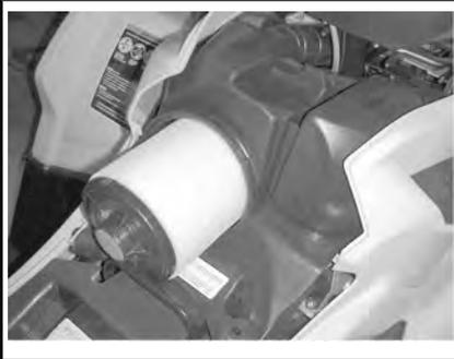
DÉPOSE DU FILTRE À AIR
