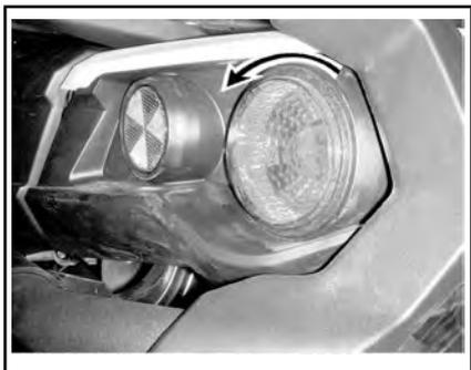
Débranchez le connecteur de l'ampoule.
