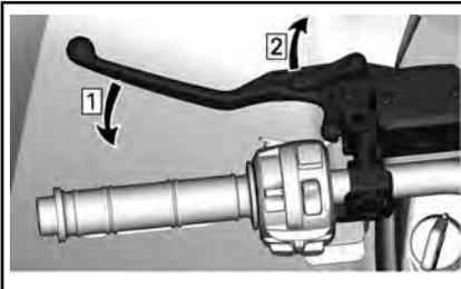
Schritt 1: *Betätigen Sie die Bremsen*
