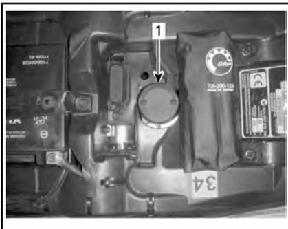
1. Behälter für Bremsflüssigkeit der hinteren Bremse
