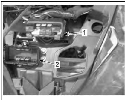
1. Vorderer Sicherungskasten
