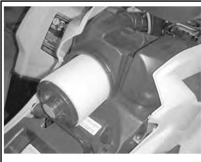
VERWIJDEREN VAN DE LUCHTFILTER
