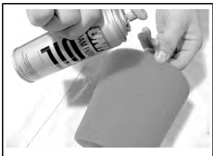
TYPISCH - FILTERELEMENT MET OLIE SMEREN
